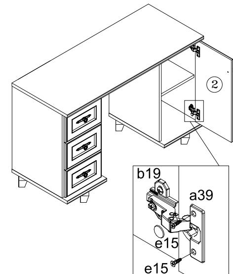
Регулювання дверей | Регулировка двери
